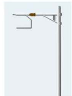
Fahrleitung, z.B. SBB 15 kV
