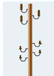
Holzmast 16 kV, kombiniert mit Niederspannung
