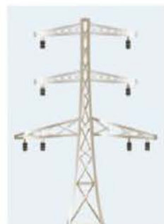
Gittermast z.B. 220 kV
